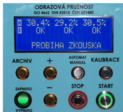
Měření prvního vzorku ukončeno kondicionování druhého vzorku
